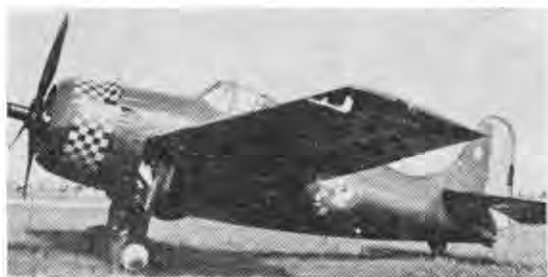
Grumman Wildcat, som Joe Foss fløy i kamp over Guadalcanal, var utstyrt med en 1200 Hk Wright Cyclone GR-1820 motor og hadde en topphastighet på 512 km/t. Rekkevidden var 1490 kilometer og største høyde 10 000 meter. Vekt 3 365 kg lastet. Spenn 11,58 meter. Lengde 8,79 meter.
